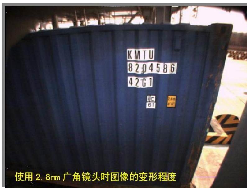
图：使用短焦距镜头带来的图像严重畸变
